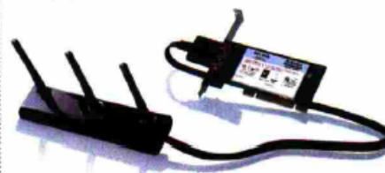
Las tarjetas PCI 802.11n tienen una antena externa de tres módulos.
